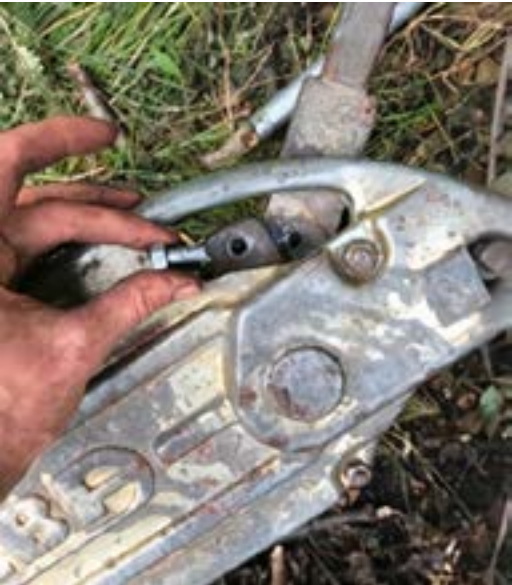
eerst zal de breekbout breken, en niet de kabel
